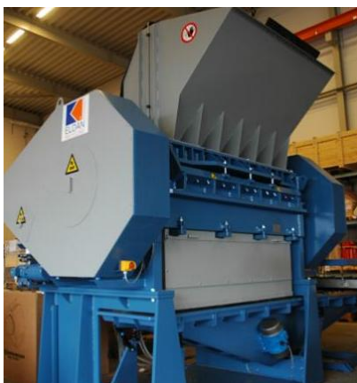
Slika 6. Višenamenski rasper za reciklažu elektronskog otpada
