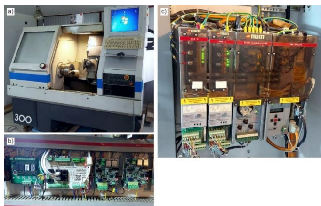
Slika 6. Modernizacija CNC struga, a) izgled CNC struga nakon modernizacije, b) ugrađeni servo drajveri DCS-100-A i ISO-USB-BOX kontroler kretanja i c) originalni servo pojačavači
